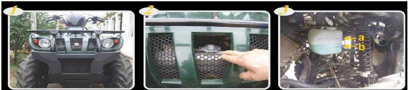
Abaisser la grille, retirer le bouchon et ajouter de l'eau. Ajouter de l'eau dans le réservoir entre les deux niveaux a et b.
